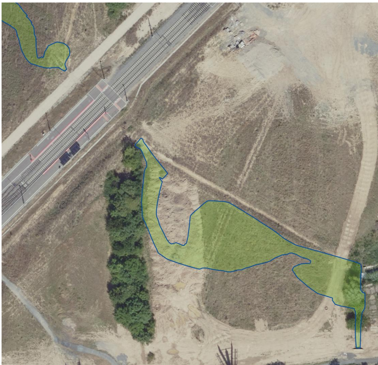
Obr. č. 11 Rozsah rozlivu Q_{100} v místě tramvajového pásu a vybudované suché nádrži.
