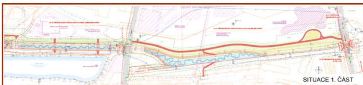
Obr. 19: Protipovodňová opatření na ochranu hl. m. Prahy, etapa 0011, část 31 (Čakovice). Fáze přípravy: Projednání dokumentace pro územní řízení. (Zdroj: VRV Praha.)
