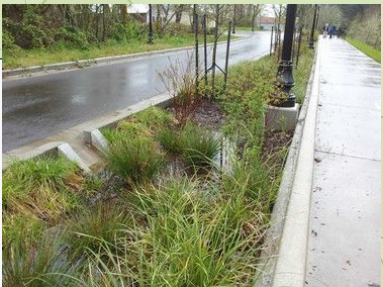
Zelené dělicí ostrůvky s funkcí modrozelené infrastruktury, zasakování srážkových vod z komunikací
