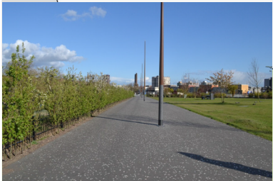
Společná stezka pro pěší a cyklisty, pouze jemné odlišení od ostatních ploch např. vsypem odlišné frakce kameniva nebo probarvením asfaltu
