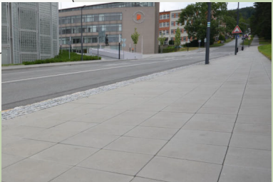
V předprostoru vstupu do Ďáblického hřbitova použití velkoformátové žulové nebo betonové dlažby, zvýšení vozovky do úrovně chodníků
